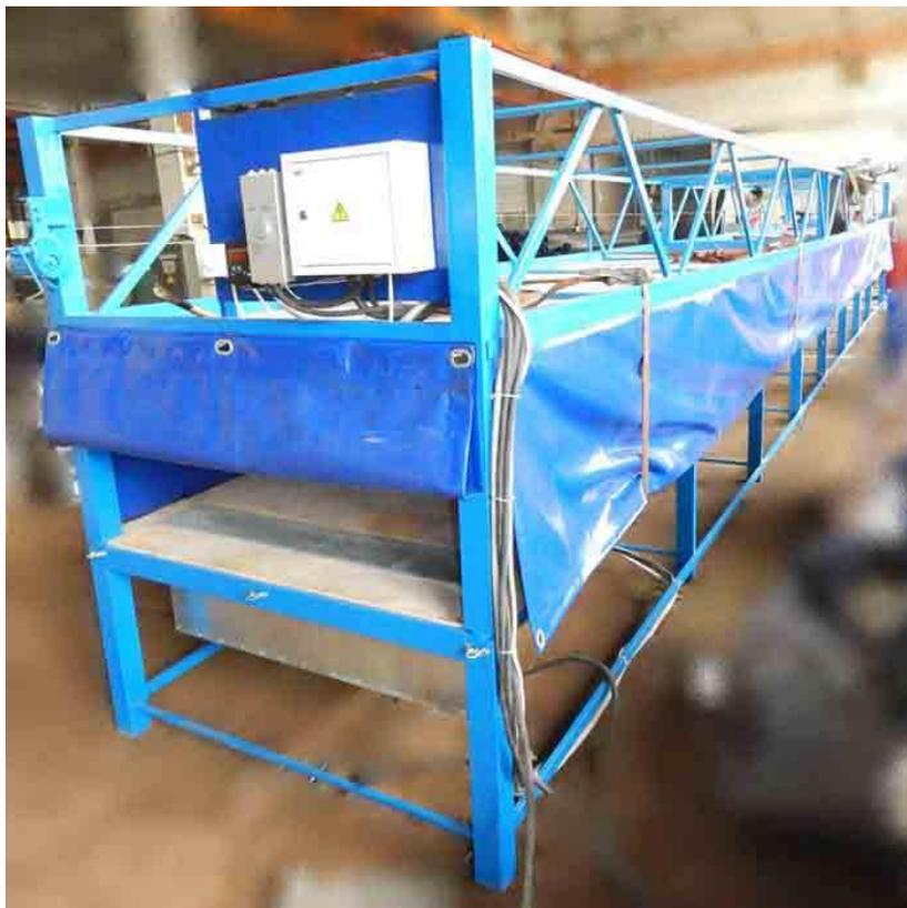
Камера предназначена для нагрева до требуемой температуры трубной сборки перед ее наливкой компонентами ППУ. Подача теплого воздуха осуществляется с торцов трубной сборки, что обеспечивает предварительный прогрев трубной сборки изнутри по всей длине за короткий промежуток времени. Движение и нагрев воздуха в камере **термостабилизации** происходит с помощью осевого вентилятора и калорифера.
